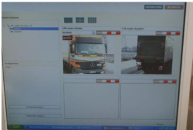
All diese An- und Ablieferungen werden jeweils bei Ein- und Ausfahrt auf einer LKW-Waage gewogen und mit dem Kfz-Kennzeichenerkennungssystem dokumentiert.
